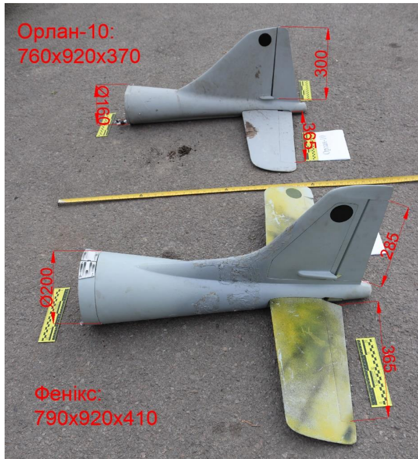
Рис. 2. Хвостова частина БпЛА Орлан-10 (зверху) та БпЛА Фенікс (знизу)
