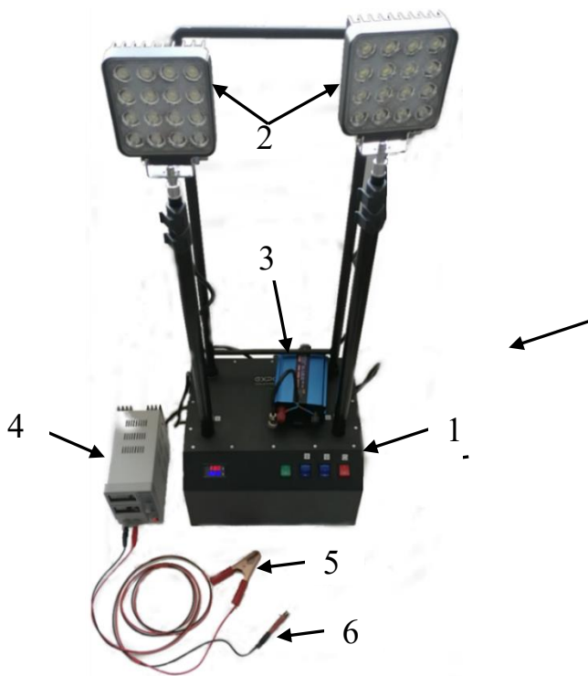
Рис. 1. Вигляд приладу «Набір для перевірки автентичності номерів на металевих поверхнях «Номер-Детект» у робочому режимі
